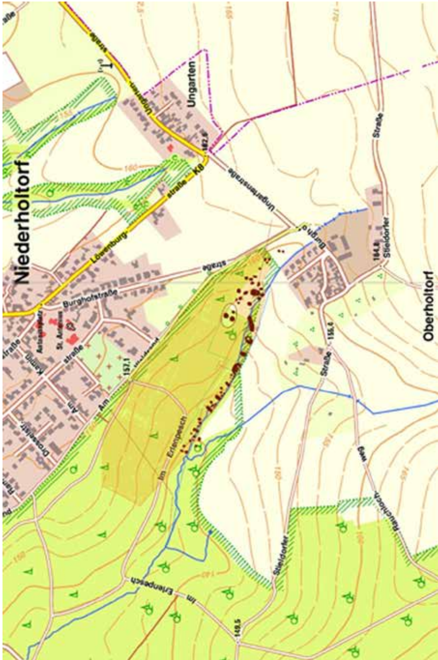
Abb. 7: Verortung des Abbaufeldes Bleibtreu aus Abb. 6 in der topographischen Karte 2017 zwischen der Straße am Waldrand und dem Ankerbach. Am Ufer des Ankerbachs erstaunlich viele Überstage-Abbaustellen und Tagebrüche
